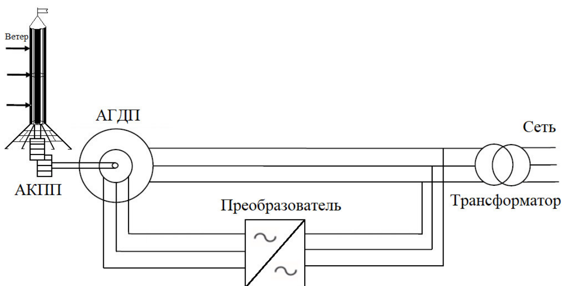
Рисунок 2.13 – Схема, иллюстрирующая работу асинхронного генератора с двойным питанием
