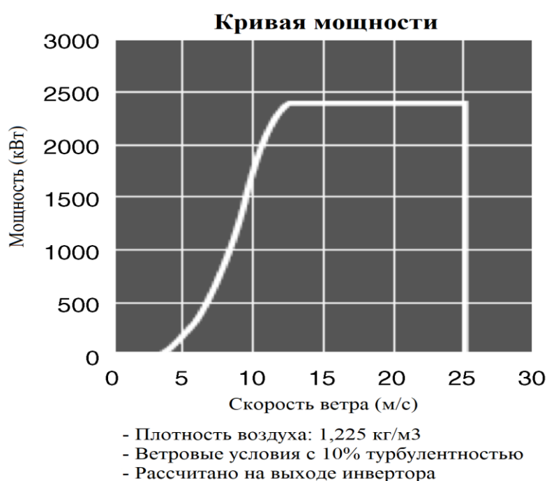
Рисунок 4.1 – Кривая мощности ветровой турбины мощностью 2,4 МВт
